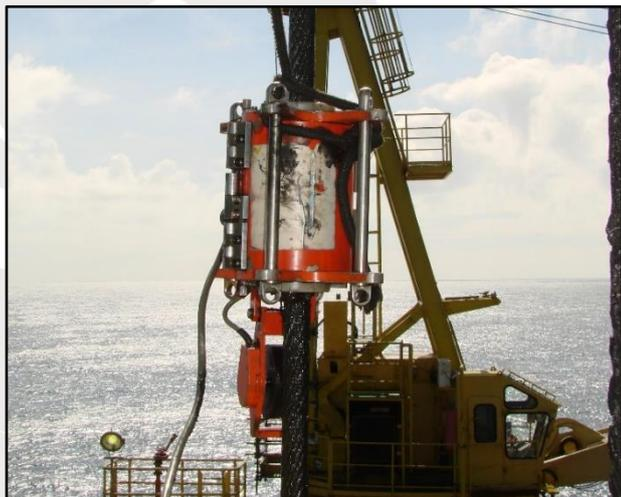
Figura 1 – MH Durante Inspeção em Cabo de Aço
